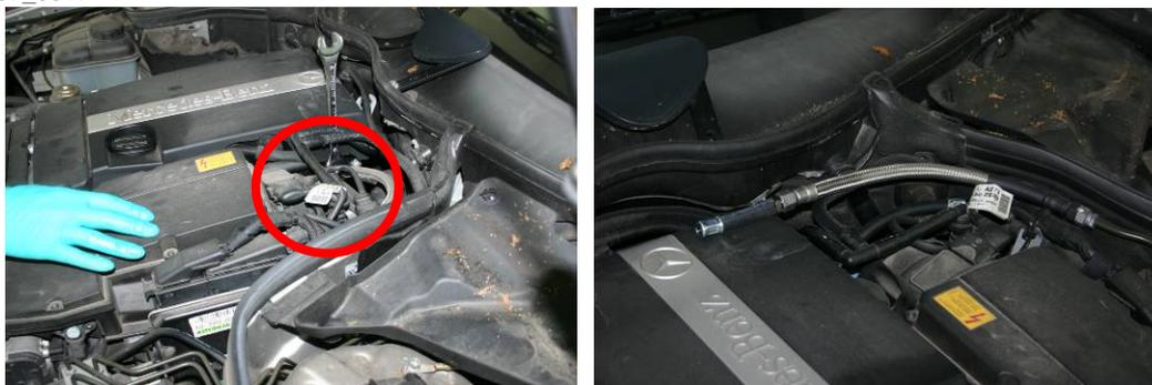
2. Entsprechenden Anschlussadapter motorseitig auf Zulauf montieren. Zulauf vom Injecto Clean Gerät mit dem entsprechenden Anschlussadapter am Motor verbinden. Bei Fahrzeugen mit Rücklauf, wird die Rücklaufleitung des Fahrzeuges mit der Rücklaufleitung des Injecto Clean Gerätes verbunden.
