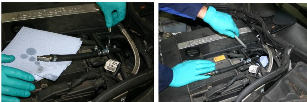
6. Motor starten und für einige Minuten im Leerlauf betreiben. Eventuell vorhandene Fehlercodes löschen. Anschlüsse des Kraftstoffsystems auf Dichtheit prüfen. Kraftstofffilter(Art.-Nr. 13310-12) in der Rücklaufleitung des Injecto Clean Gerätes tauschen.
