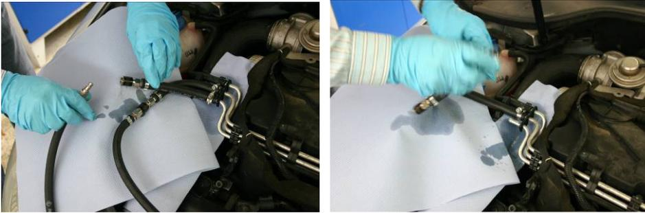
6. Motor starten und für einige Minuten im Leerlauf betreiben. Eventuell vorhandene Fehlercodes löschen. Anschlüsse des Kraftstoffsystems auf Dichtheit prüfen. Kraftstofffilter (Art.-Nr. 11 13310-12) in der Rücklaufleitung des Injecto-Clean Gerätes tauschen
