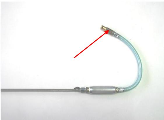
4. Die von der Kombisonde abgebaute Bajonettkupplung an das Schlauchende der flexiblen Sonde anschrauben.
