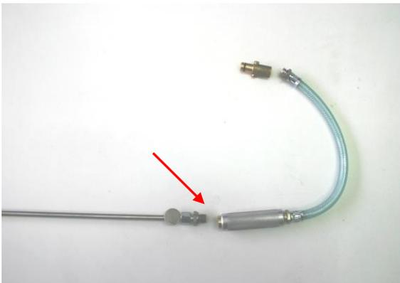
3. An die 1/4 Zoll Verschraubung der Sonde wird das Griffstück der flexiblen Sonde montiert.
