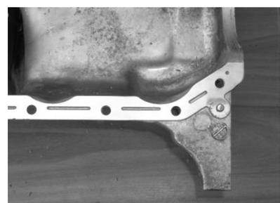
4. Der Silikondichtstoff ist in geschlossener Raupenform auf eine der Füge­teil­flächen aufzutragen. Es muss flächendeckend eine optimale Produkt­verteilung / Benetzung sichergestellt werden.
