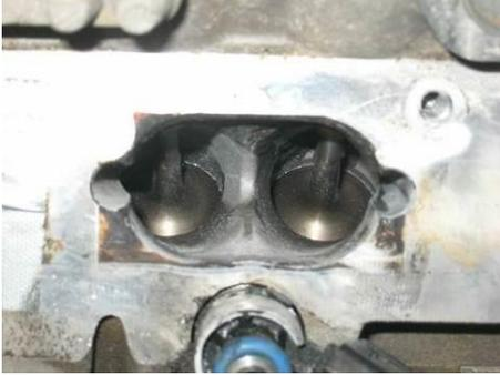
14. Vérifier le nettoyage (avec un endoscope si nécessaire). Répéter l'opération autant de fois que nécessaire pour obtenir un résultat satisfaisant.
