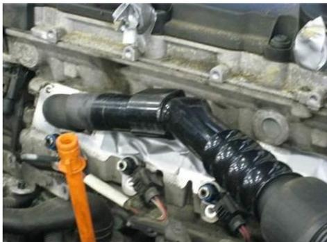
7. Ajuster le cylindre à nettoyer au point mort pour s'assurer que les soupapes soient fermées. Remarque : Le nettoyage ne peut être effectué que si les soupapes sont fermées.
