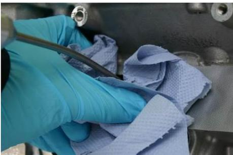
20. Couvrir les conduits d'admission avec un chiffon et utiliser la soufflette (4) pour se débarrasser des résidus de la solution de neutralisation.
