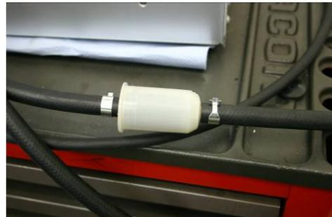
15. Se l'Injecto Clean non viene utilizzato per più di 2 giorni oppure è destinato ad una pulizia di un altro tipo di carburante, il serbatoio del sistema ed i tubi di collegamento devono essere svuotati. Montare connettori su tutti i due tubi e metterli in un contenitore adatto (volume di almeno 1 lt). Accendere l'Injecto Clean e fare fuoriuscire tutto il liquido residuo. Spegnerlo e scollegare dalla batteria il sistema Injecto Clean e smontare i connettori.
