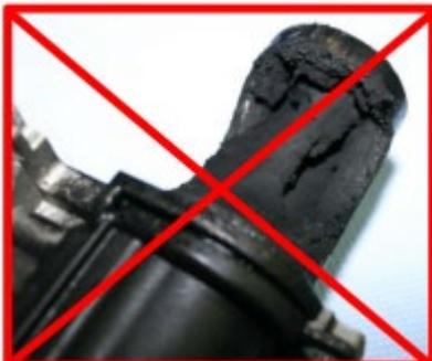
**Componenti imbrattati non devono essere puliti da montati, in quanto depositi sciolti e il detergente possono provocare danni importanti al motore e al sistema di scarico!**
