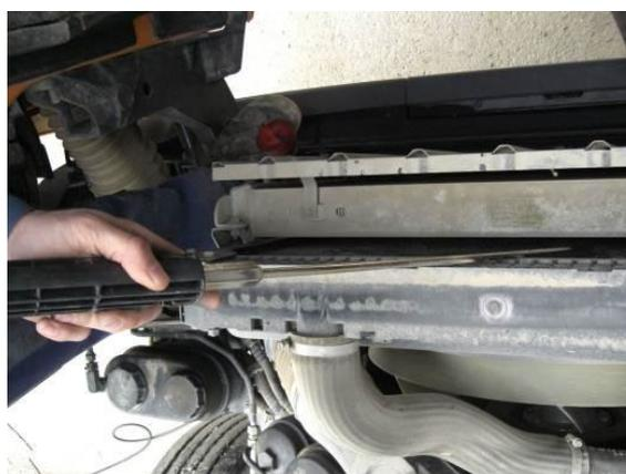
6. Lasciare agire per 3-5 minuti il detergente Professional 141 e successivamente sciacquare abbondantemente con acqua, impostando il dosaggio sulla posizione minima dell'idropulitrice.
