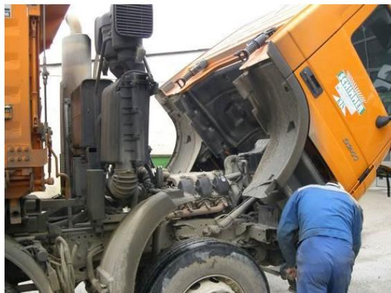
5. Pulire le masse radianti inserendo la sonda negli spazi direzionando il getto dalla parte opposta al flusso dell'aria ed erogare il detergente Professional 141 partendo dal radiatore di raffreddamento. Successivamente pulire anche l'intercooler.
