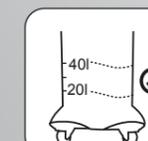
Aggiungere del liquido se necessario: livello min 20L - max 40L
