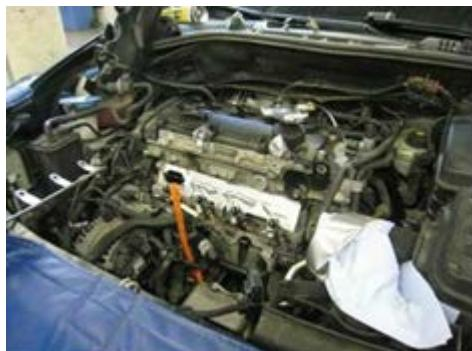
1. Proteggere parti delicati del motore (es. Cablaggi, parti in gomma o in plastica).
