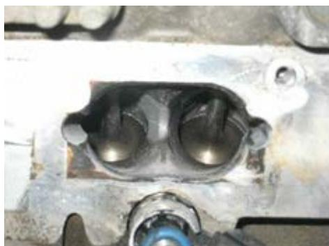
13. Verificare il successo della pulizia mediante un endoscopio, se necessario, ripetere l'operazione fino alla completa pulizia.
