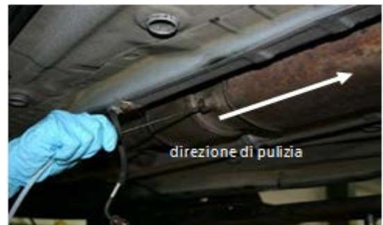
3. Effettuare la pulizia con il TUNAP microflex® PREMIUM 931 (2 x 1 litro - azionare la pistola ad intervalli di 3/5 secondi).
