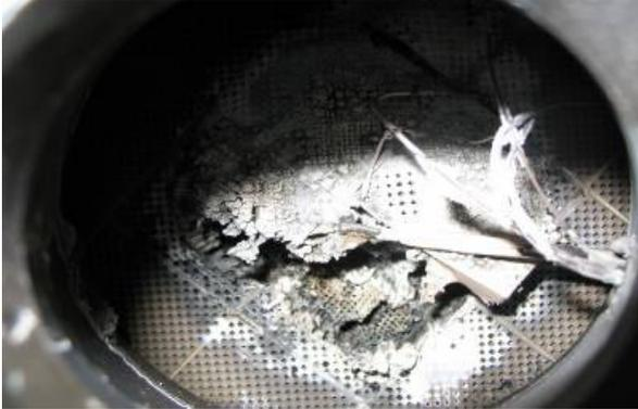
In caso di filtri antiparticolato danneggiati meccanicamente, come nella foto sopra, è inutile fare una pulizia e il filtro va sostituito.
