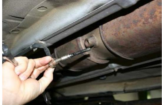
2. Utilizzare la sonda con foro dritto oppure con fori laterali e fare la pulizia in direzione del filtro antiparticolato. Se fosse necessario piegare leggermente la sonda TUNAP.
