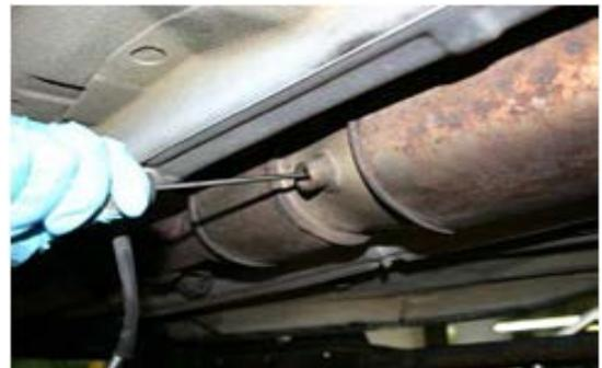
4. Dopo la pulizia nebulizzare la sostanza di risciacquo TUNAP microflex® PREMIUM 932. Se il filtro è molto intasato aspettare 10 minuti prima di fare il risciacquo.
