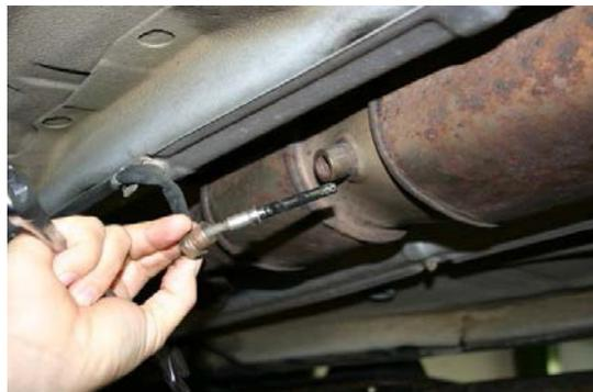
2. Inserire la sonda TUNAP nell'apposito foro creatosi ed effettuare la pulizia in direzione del filtro antiparticolato. In caso fosse necessario piegare leggermente la sonda TUNAP.
