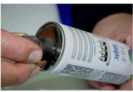
2. Avvitare l'adattatore per l'aria TUNAP 134 2 nell'apertura rimasta libera nella base del flacone.
