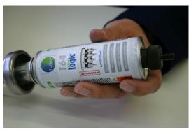
4. Avvitare il flacone, compreso l'adattatore per l'aria TUNAP 134 2, sull'adattatore TUNAP utilizzato, fino ad avvertire una leggera resistenza.
