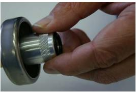
7. Svitare l'adattatore TUNAP utilizzato dalla presa di carica del serbatoio. Rimettere il tappo del serbatoio.
