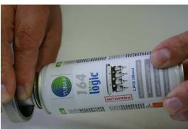
6. Mantenere fermo con una mano l'adattatore TUNAP utilizzato e svitare il flacone.
