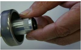
Togliere il tappo del serbatoio del gas. Avvitare bene l'adattatore idoneo TUNAP sul raccordo del serbatoio. Se necessario, usare adattatori intermedi comunemente in commercio.
