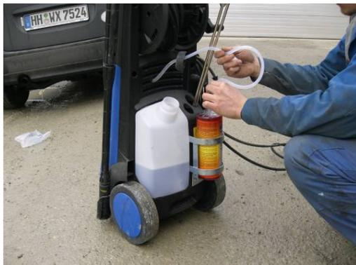
1. Posizionare il pulitore nel relativo supporto sull'idropulitrice e inserire il tubo di pescaggio.
