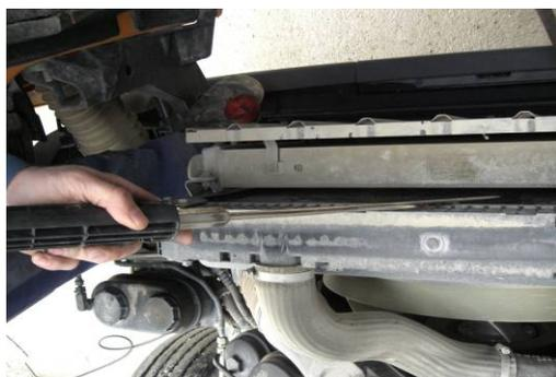
5. Inserire la sonda TUNAP tra il radiatore motore e l'intercooler, direzionando il getto dalla parte opposta del flusso dell'aria ed erogare il detergente TUNAP 641.
