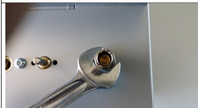
Smontare l'innesto TUNJET per aria compressa (SW14)
