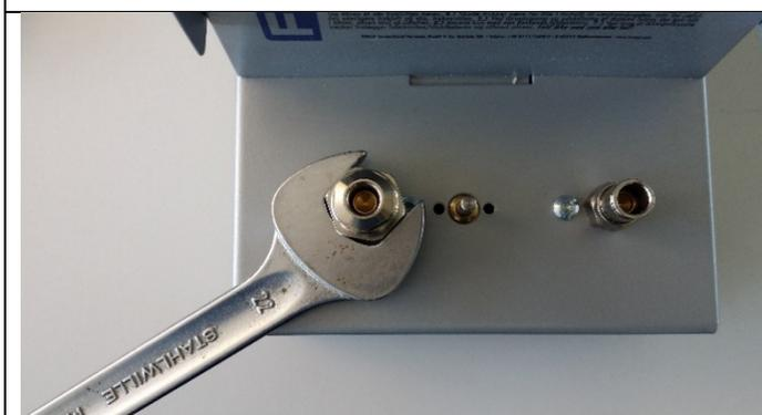
Smontare l'innesto TUNJET per il riempimento con aria e detergente (SW22)
